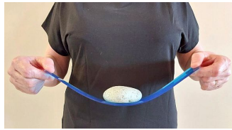
Une latte, tenue droite, sur laquelle on met un poids, plie... La même latte que l'on courbe vers le haut, ne plie pas...
