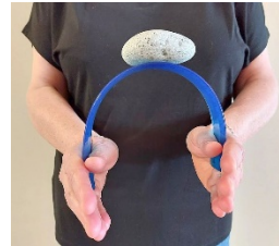
Une latte, tenue droite, sur laquelle on met un poids, plie... La même latte que l'on courbe vers le haut, ne plie pas...
